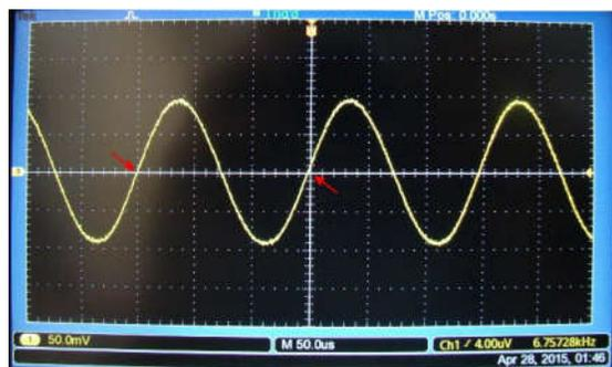
Figura 3.7: Detalhes para leitura do período e determinação da frequência do sinal alternado. As setas indicam o intervalo que deve ser considerado para leitura de um ciclo completo do sinal de entrada.
