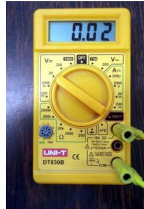
Figura 2.7: Multímetro configurado como amperímetro para leitura de corrente elétrica com fundo de escala de 10 A.
