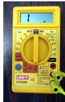
Figura 2.1: Multímetro configurado como ohmímetro para leitura de resistência elétrica. As escalas para média de resistência elétrica estão destacadas em coração mais escura. As pontas de provas devem ser ligados nos terminais COM e V- $\Omega$ -mA para realizar a medida.
