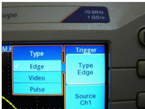
Figura 3.9: Escolha do tipo e fonte do Trigger
