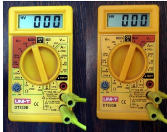
Figura 2.3: Multímetro configurado para leitura de tensão. A imagem da esquerda a chave seletora está posicionada para realizar medidas de tensão contínua e a imagem da direita selecionada para medida de corrente alternada.
