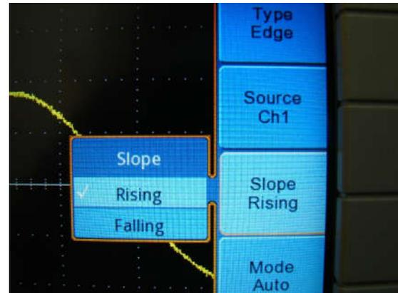
Figura 3.10: Sub menu do trigger, ilustrado a opção Slope.
