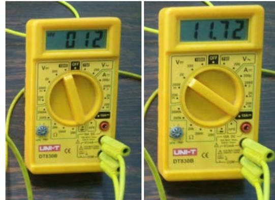
Figura 2.5: Multímetro configurado como voltímetro para medida de tensão. A imagem à esquerda mostra leitura realizada com o fundo de escala para 1000 V e a imagem da direita a leitura para a mesma valor de tensão só que com um fundo de escala de 20 V, onde é possível observar uma maior resolução da medida.
