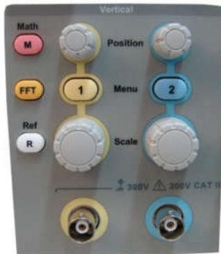
Figura 3.2: Controles verticais para os canais de entrada 1 (em amarelo) e 2 (em azul). Entradas pontas de prova são conectores do tipo BNC de 50Ω.
