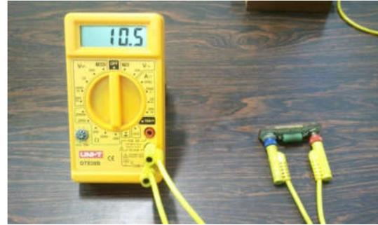
Figura 2.2: Leitura da resistência elétrica de um resistor. As mãos não devem tocar simultaneamente as duas pontas de prova.
